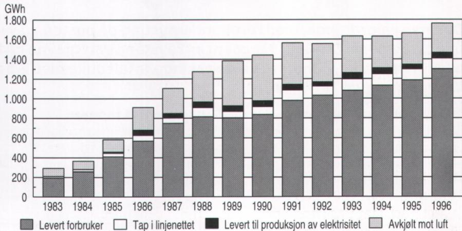
knapt 9 prosent mer enn nivået året før. Nettoproduksjonen er total produksjon fratrukket det som er levert til kraftproduksjon og det som går tapt ved at varme avkjøles mot luft.
